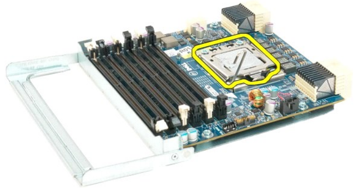
71. قم بإزالة المعالج ثنائي المراكز من لوحة المعالج ثنائي المراكز.
