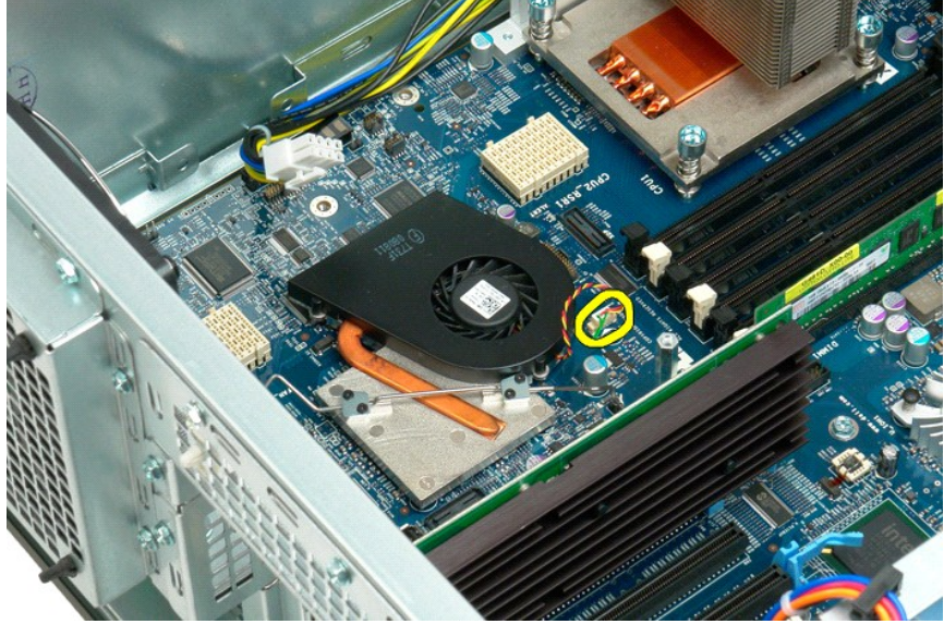
5. قم بتحرير مشبك الاحتجاز المعدني من لوحة النظام من طرف واحد.
