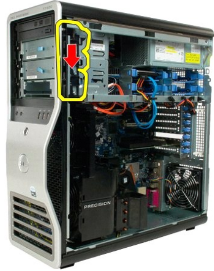
5. قم بتمرير محرك الأقراص الضوئية إلى خارج الجزء الأمامي من الهيكل، ثم قم بإزالة محرك الأقراص الضوئية من الكمبيوتر.
