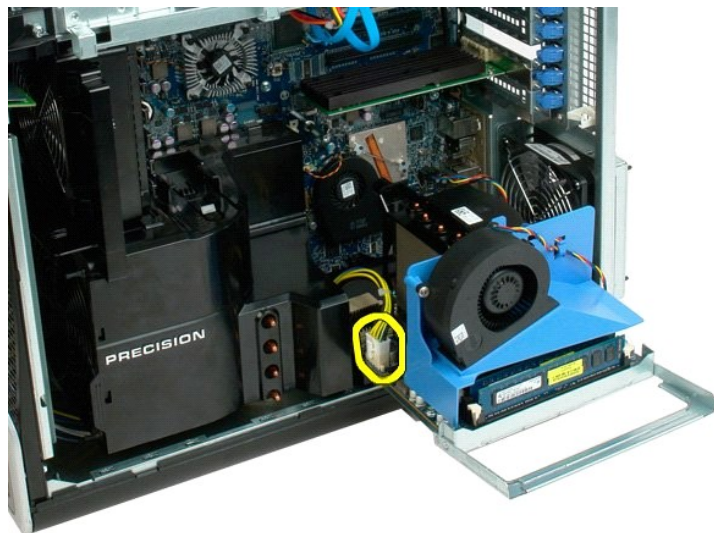
5. قم بفصل كابل الطاقة عن لوحة المعالج ثنائي المراكز.
