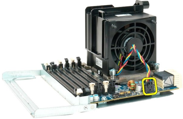
21. قم بترك مسامير التثبيت الرباعية الموجودة على مجموعة وحدة امتصاص الحرارة/المروحة الخاصة بالمعالج ثنائي المراكز.
