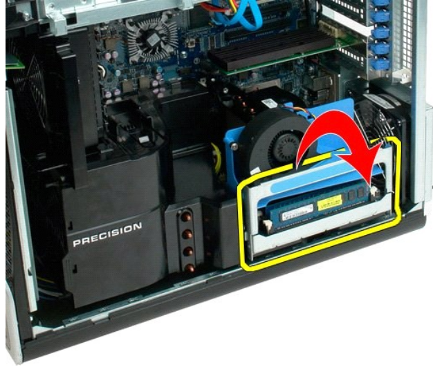
4. قم بتحريك قاعدة المعالج ثنائي المراكز جزئيًا نحو الخارج مع توخي الحرص.
