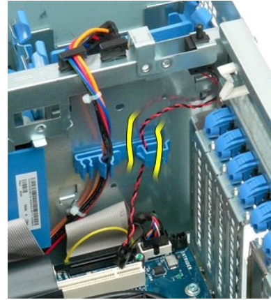
5. قم بتحريك مفتاح منع الوصول باتجاه مركز الكمبيوتر.
