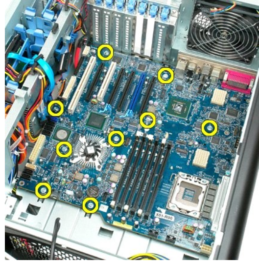
02. قم بتحريك لوحة النظام تجاه الجزء الأمامي من الكمبيوتر.
