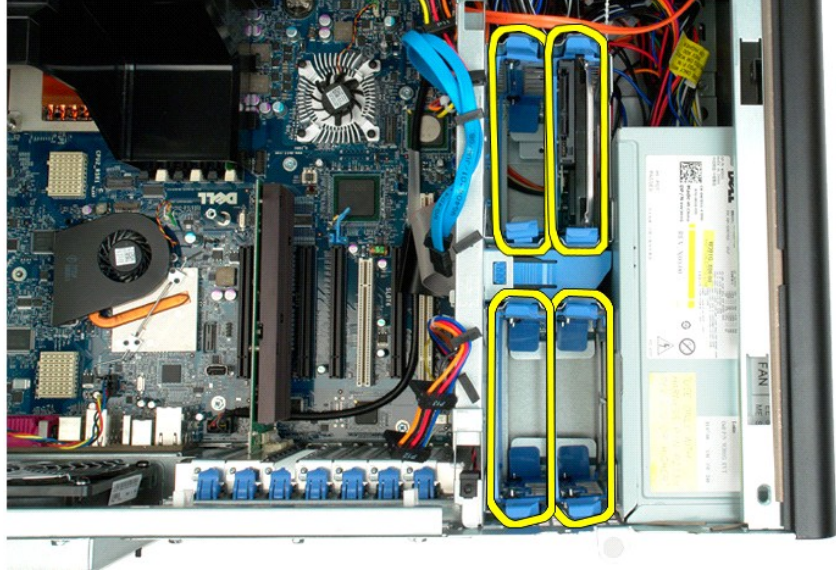
4. قم بإزالة المسامير اللولبية التي تقوم بإحكام تثبيت حاوية محرك الأقراص الصلبة الأول بالهيكل.
