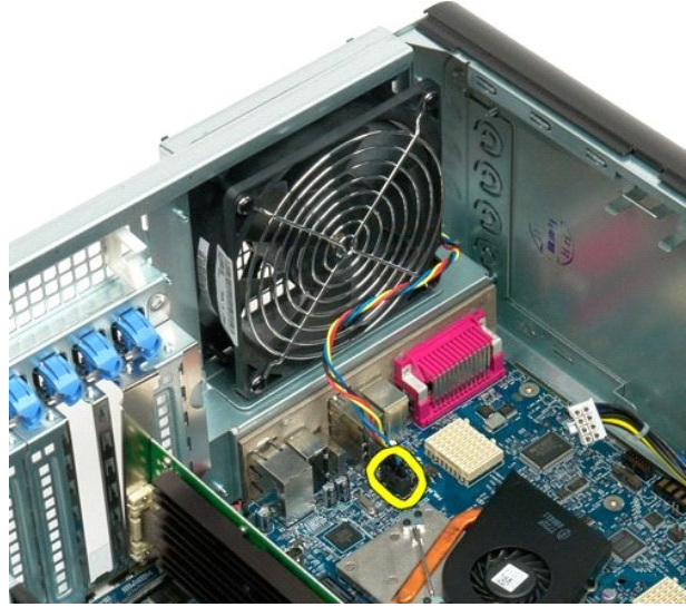
4. من خارج الكمبيوتر، قم بسحب كل حامل من الحوامل المطاطية الأربعة السوداء اللون لتحرير المروحة من الكمبيوتر.
