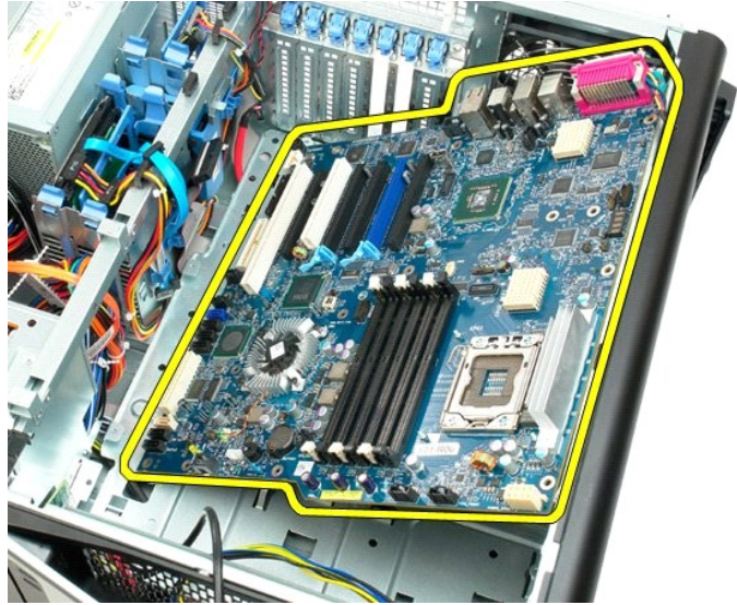
22. قم ب إزالة لوحة النظام من الهيكل.
