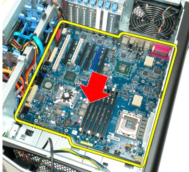
12. ارفع لوحة النظام لأعلى بزاوية تجاه الجزء السفلي من الكمبيوتر.
