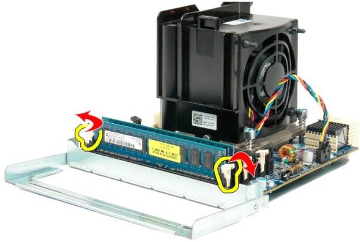
11. قم بإزالة وحدة الذاكرة الأولى من لوحة المعالج ثنائي المراكز، ثم كرر نفس العملية على أي من وحدات الذاكرة المثبتة.
